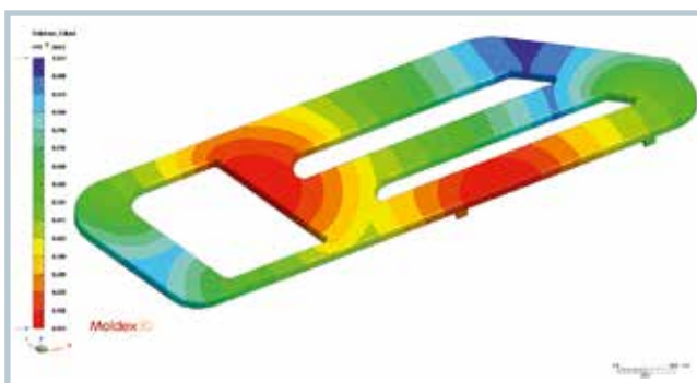
Bild 4. Der Verlauf der Fließfront mit den gewählten zwei Anschnitten zeigt die Lage der Bindenähte (links). Die Position der Bindenähte kann auch einzeln dargestellt werden (rechts)
